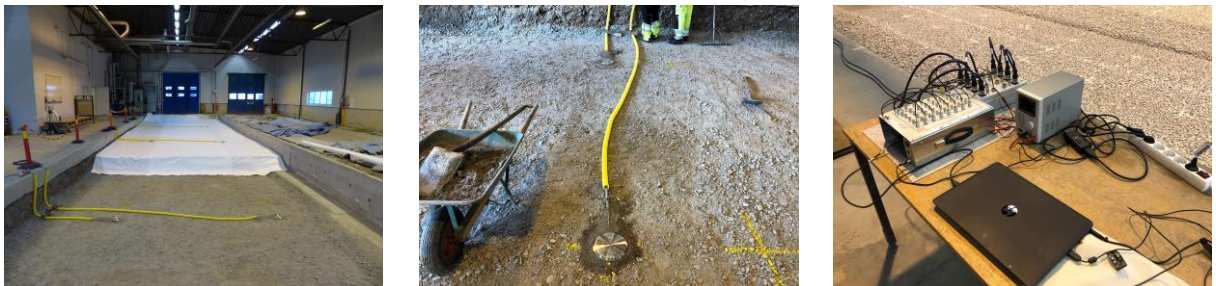
Figur 5. Fotografier från försöksberedning. T.v. översikt av trycksensorer utplacerade i kanal. C. Närbild utplacering av trycksensor. T.h. Uppställning av kopplingsbox, ström-matning och mätdator.
