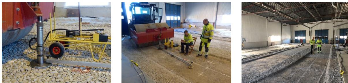
Figur 19. Fotografi visandes genomförande av statisk plattbelastningstest DIN 18134.
