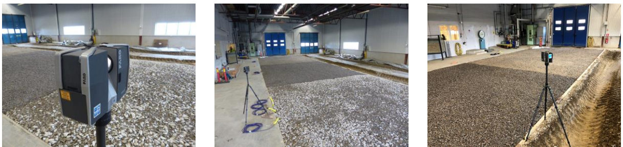
Figur 8. Fotografi som visar FARO Focus 3D utrustning på stativ.
